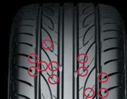
В отличие от обычных канавок, канавки уменьшенной глубины имеют дополнительное влияние на характеристики шины. Увеличивают жесткость блоков протектора и делают отклик на управляющие воздействия более четким.
