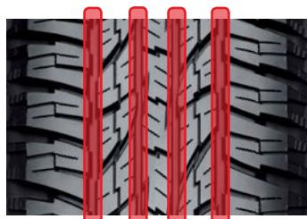
Четыре основные прямые канавки способствуют отводу воды из пятна контакта, улучшают показатели аквапланирования и торможения на мокром покрытии.
