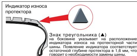
Знак треугольника (▲) на боковине указывает на расположение индикатора износа на протекторной части шины. Появление индикатора соответствует остаточной глубине протектора в 1,6 мм, что говорит о необходимости замены шины.
