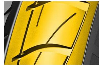
Поперечные канавки и сплошные плечевые ребра повышают жесткость плечевой зоны, контролируя устойчивость движения на поворотах.
