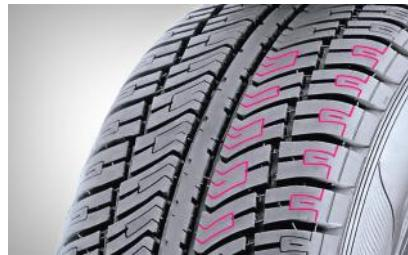
Тонкие ножевые прорези, предусмотренные для повышения защиты от аквапланирования, способствуют разделению водяной пленки.
