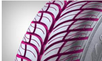
Широкие направленные водоотводящие канавки и специальные дренажи: эффективный отвод воды
