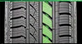
Оптимальную управляемость и уменьшение уровня внутреннего шума обеспечивают открытые блоки ребра, соединенные профильными перемычками.
