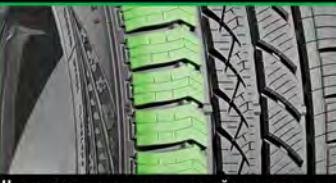
Надежное сцепление с дорогой на поворотах гарантируют блоки плечевых зон, имеющих изогнутый профиль.
