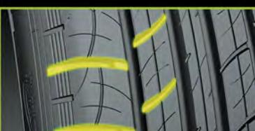
Поперечные канавки разделены широкими окружными каналами, выходят под разными углами к направлению вращения шины. Они имеют переменную глубину и ширину, что позволяет избежать излишних завихрений воздуха, способствует быстрому оттоку воды, предотвращает возникновение неприятного звука и заметно улучшают акустический комфорт.
