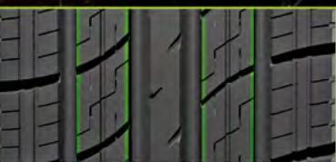
Срезанные края блоков протектора способствуют более равномерному износу шины, а также снижению уровня шума.
