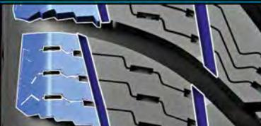
Боковая устойчивость на укатанном снегу обеспечивается агрессивными грунтозапечатками без скруглений. Дополнительное боковое сцепление в поворотах за счет косых поперечных канавок с оптимизированным углом наклона.
