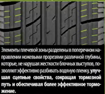
Элементы плечевой зоны разделены в поперечном направлении ножевыми прорезями различной глубины, которые, не нарушая жесткости блочных выступов, позволяют эффективно разбивать водяную пленку, улучшая сцепные свойства, сокращая тормозной путь и обеспечивая более эффективное торможение.
