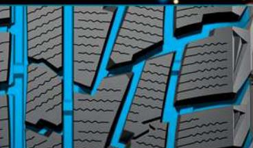
Продольные и поперечные канавки отводят воду из пятна контакта шины с дорогой, предотвращая возникновение эффекта аквапланирования. Широкие каналы между блоками протектора хорошо самоочищаются, позволяя самим блокам глубоко впечатываться в снег и грязь до твёрдой поверхности дороги.
