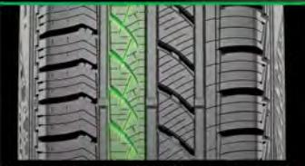
Увеличению сцепления с мокрым дорожным покрытием и снегом способствуют разнонаправленные канавки, которые интенсивно разделяют полузакрытое центральное ребро внутренней части протектора.
