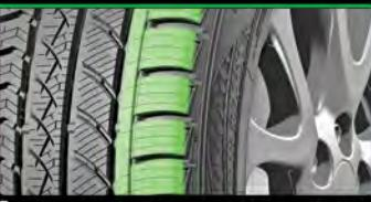
Точность управления на сухом дорожном покрытии, улучшенное сцепление при маневрировании и сокращение тормозного пути происходит за счет внешних шашек, объединенных единым ребром протектора.
