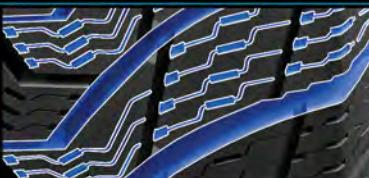
Повышенное сцепление с мокрой дорогой и защита от аквапланирования. Оптимальный угол наклона широких канавок позволяет максимально быстро отводить воду и снежную кашу из пятна контакта. Высокая плотность маленьких поперечных канавок создает многочисленные дополнительные грани, которые разрезают водяную пленку.
