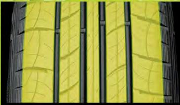
Всесезонный рисунок протектора шины формируется из центрального ребра и четырех окружных рядов отдельных элементов — двух средних ребер и двух крайних жестких плечевых блоков.
