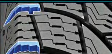
Повышенная устойчивость и сцепление на укатанном снегу и льду за счет зубчатых уступов на крайних грунтозапечатках.
