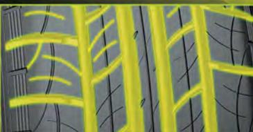
Протектор с продольными широкими каналами, ножевыми прорезями, поперечными канавками состоит из трёх слоев резины с различными свойствами, снижает сопротивление качению и увеличивает сцепление с дорогой.
