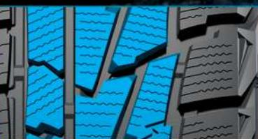
Благодаря различным углам расположения кромок зацепления, три продольных ребра, разделённые наклонными стреловидными канавками, позволяют шине эффективно работать в любых ситуациях: при разгоне, торможении и прохождении поворотов.
