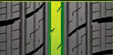
Центральное ребро, рассеченное выемками, имеет монолитную форму, поддерживает среднюю зону протектора, повышает устойчивость автомобиля и точность рулевого управления при движении на высоких скоростях.
